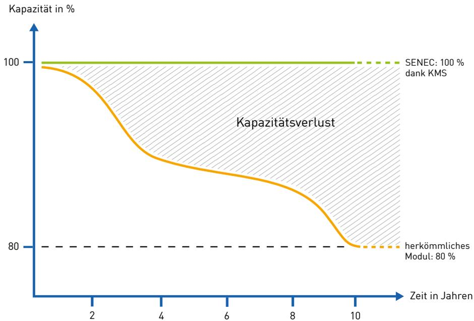
**Für den SENEK.Home V2.1 haben wir unser Batterie-Management-System erweitert.** Daraus entstanden ist das am Markt einzigartige Kapazitäts-Management-System (KMS). Es kombiniert eine neue Zelltechnologie mit speziell zugeschnittener Software-Aussteuerung und einer Sicherheitsreserve innerhalb dieser Zellen.
